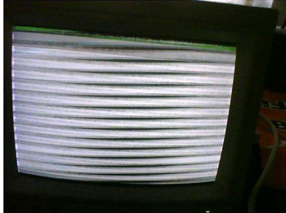
Bild 1: Inkompatibler Auflösungsmodus bei einem analogen Monitor
