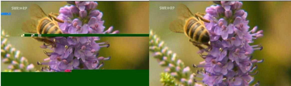
Bild 7 (links): Ein weiterer wiederhergestellter I-Frame aus test4.ts Man bedenke, dass die obere Hälfte des Bildes bis zum 16 Pixel großen, grünen Balken aus einem zukünftigen I-Frame stammt.
