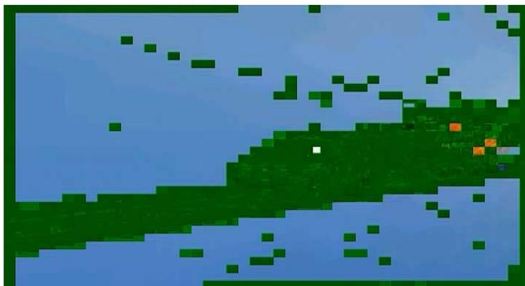
Bild 48: B-Frame ohne vorhergehenden I-Frame aus einem der Videoströme aus sample.ts.
